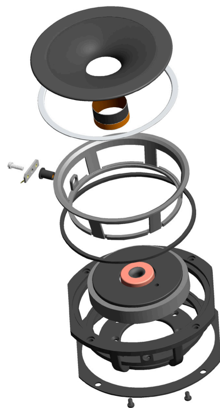
HHCM SL EXPLOSIONSZEICHNUNG / EXPLODED VIEW
